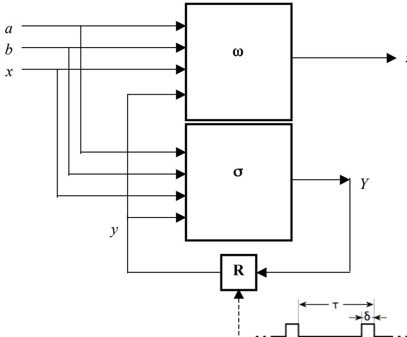
Visto che  $R$  è standard, la realizzazione della rete sequenziale si riduce alla realizzazione delle due reti combinatorie corrispondenti alle funzioni  $\omega$  e  $\sigma$ .
