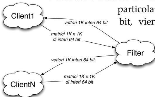
I dati sono matrici  $1K \times 1K$  di interi a 64 bit. Sulle matrici viene effettuato un particolare calcolo, e il risultato, un vettore da 1K interi a 64 bit, viene restituito al processo Client che ha inviato la matrice. Si dettagli il codice dei processi e si fornisca la compilazione in codice assembler della porzione di codice che effettua la spedizione della matrice nei processi client.
