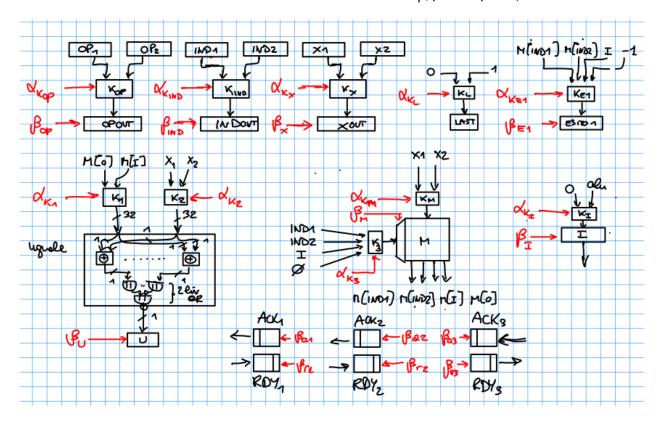
OPOUT, INDOUT e XOUT devono essere intesi come risultato della scelta fra OP1 e OP2, IND1 e IND2 e X1 e X2, quindi avranno un commutatore in ingresso. Il cammino più lungo fra l'uscita di un
