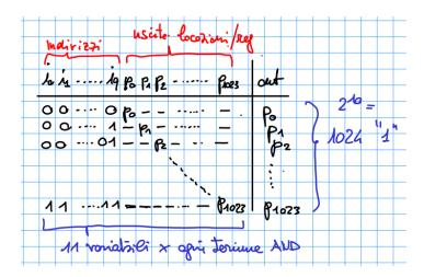
Il livello AND sarà costituito dunque da un albero di porte a due livelli. Il livello OR ha 4 livelli (parte intera superiore del logaritmo in base 8 di 1024,  $\log_8 1024 = \log_2 1024 / \log_2 8 = 10 / 3 = 3.3$ ). Quindi in totale il tempo di accesso sarà di  $\delta t_p$ .
