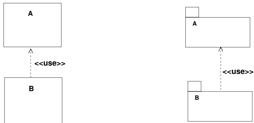
Figura 3: Vista strutturale d'uso: per rappresentare la relazione "usa (dipende da)" si utilizza la freccia che indica dipendenza, etichettata con <<use>>.
